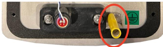
Raccordement du contact de détection d'ouverture (Version DO)
