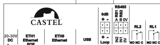
**Raccordement au bus RS485 VDIP (RS1 / RS2 / 0V) Configurable par CASTELSuite**
