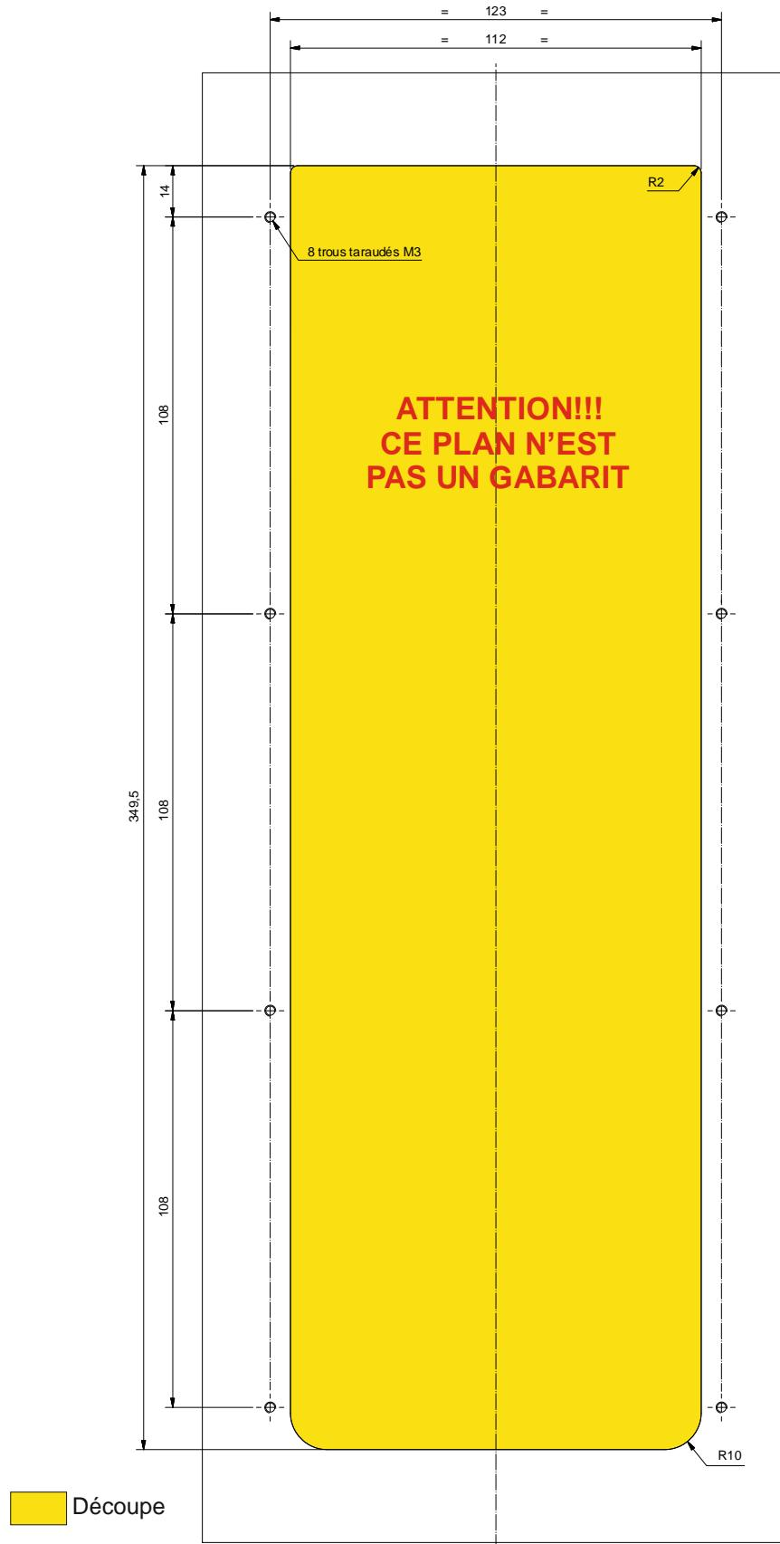
**Montage en encastrement des modèles avec clavier numérique**
