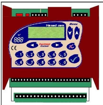
**Etape 7 :** retourner la centrale, et positionner les quatre languettes en biais.
