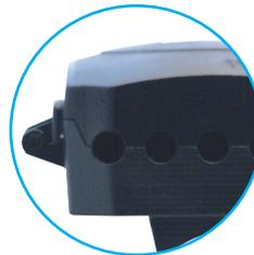
Boîtier de mât avec charnières et fermeture rapide mono point à verrouillage. Etanchéité assurée par double chicanes + joints. Mousses «presse étoupe» d'étanchéité et de maintien des câbles.
