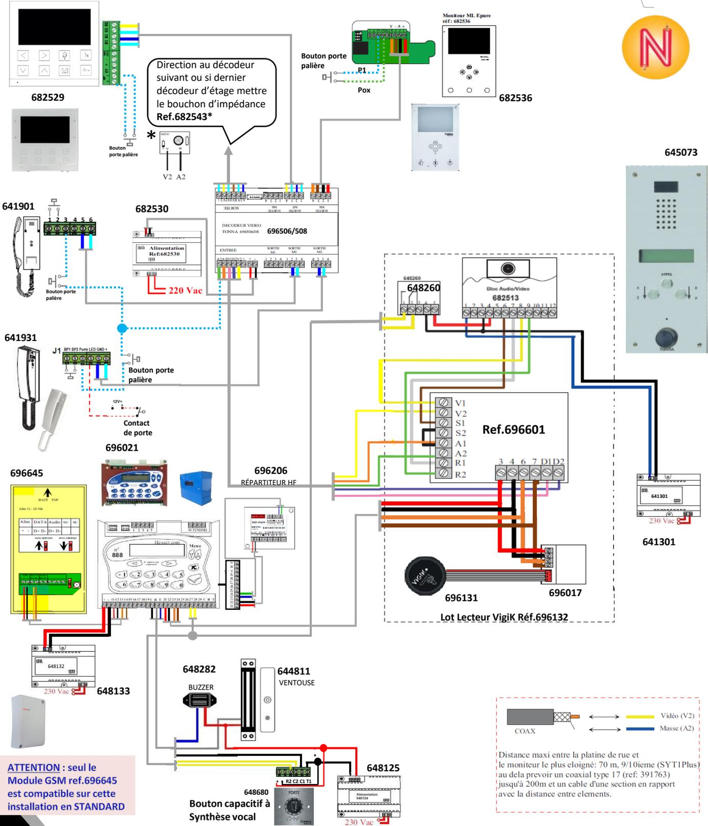
Distance maxi entre la platine de rue et le moniteur le plus éloigné: 70 m, 9/10ème (SYT1Plus) au delà prévoir un coaxial type 17 (ref. 391763) jusqu'à 200m et un câble d'une section en rapport avec la distance entre éléments.
