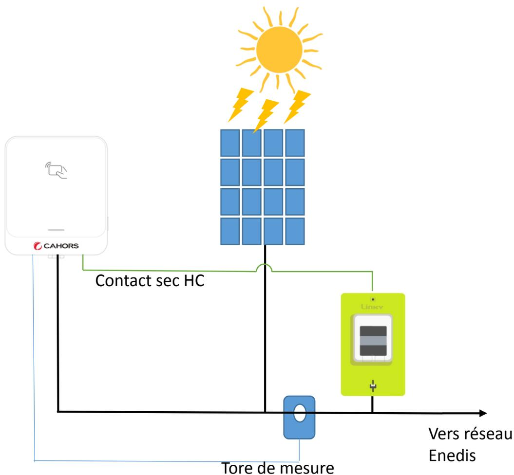
\*Schéma de principe du raccordement pour une exploitation optimale de périodes tarifaires et de l'apport solaire
