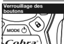
La fonction **Lock (Verrouillage)** verrouille les boutons **Channel Up (Canal supérieur)**, **Channel Down (Canal inférieur)**, **Volume Up (Augmentation du volume)**, **Volume Down (Réduction du volume)**, **TRI Watch**, **MEM/ESC**, **Scan** et **Mode/ Power (Mode/Alimentation)** pour éviter toute pression accidentelle.
