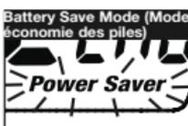
S'il n'y a pas de transmissions dans les 10 secondes, la radio passe automatiquement en mode **Battery Save (Économie des piles)** et l'icône **Power Saver (Économie d'énergie)** clignote sur l'écran. Cela n'affectera pas la capacité de la radio à recevoir les émissions entrantes.
