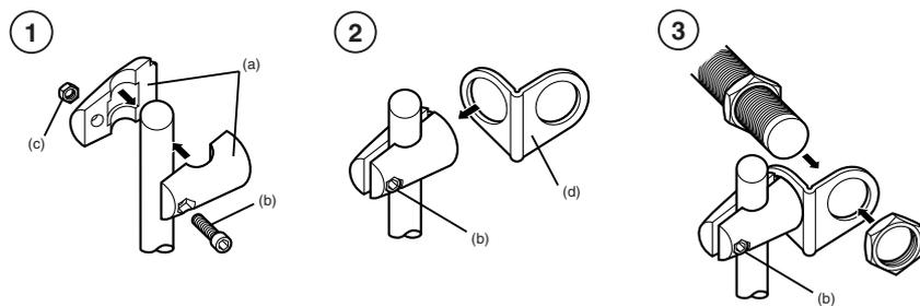
Monter les deux parties de la bride de fixation (a) provisoirement à l'aide de la vis (b) et de l'écrou (c) livrés.
