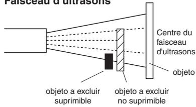
La suppression de la cible perturbatrice est effectuée via la réduction de la sensibilité de la réponse. Cette illustration montre son effet sur les caractéristiques de réponse du détecteur. Le détecteur est programmé à l'étape 1 par le fabricant.
