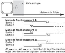
A1 → ∞ , A2 → ∞ : Détection de la présence d'un objet. Les deux sorties agissent conformément au mode de fonctionnement réglé lorsqu'il y a un objet dans la plage de saisie.
