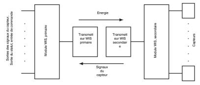
La somme des courants de repos de tous les capteurs reliés au module WIS secondaire ne doit pas excéder le courant transmissible maximal. Celui-ci correspond à la puissance transmissible par les transmetteurs / 12 V.
