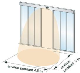
Hauteur de montage 2 200 mm / Angle du champ de détection 30°
