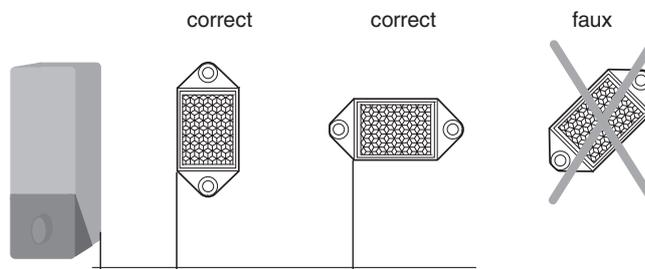
Le bord du détecteur et le bord du réflecteur doivent être parallèles !
