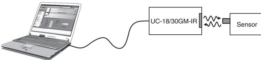
Le logiciel de paramétrage ULTRA-PROG-IR est également nécessaire pour définir les paramètres du détecteur. Le logiciel ULTRA-PROG-IR peut être téléchargé gratuitement sur le site Web [www.pepperl-fuchs.com](http://www.pepperl-fuchs.com). Il permet de définir l'ensemble des paramètres ouverts, y compris :
