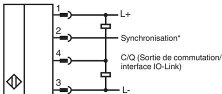
\*si inutilisée, connecter à la terre (0V)
