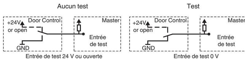
Si le dispositif n'est pas utilisé comme barrière de sécurité conformément à la norme DIN 18650 / EN 16005, il n'est pas nécessaire de connecter l'entrée de test.
