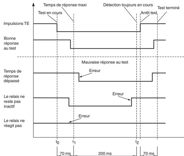
Le contrôleur de porte doit interroger la cellule aux temps  $t_1$  et  $t_2$ .
