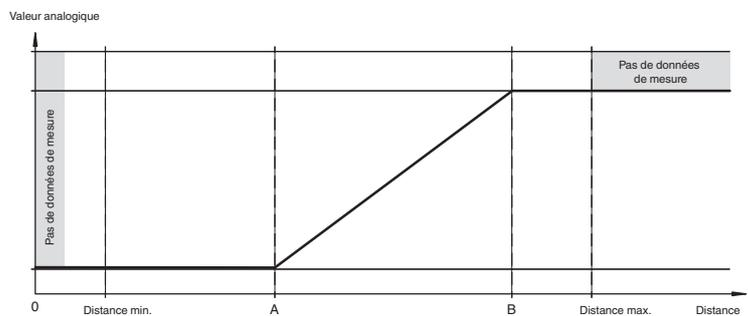
**Rampe descendante (A > B)**
