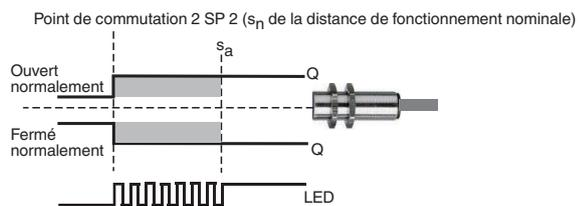
Mode fenêtre avec alarme de stabilité
