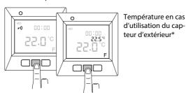
\*Si le thermostat est réglé sur capteur d'extérieur, sinon c'est la température ambiante (R) qui s'affiche.
