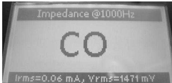
Dans le cas opposé où la valeur mesurée est inférieure à 4 ohms l'appareil va afficher « CC ».
