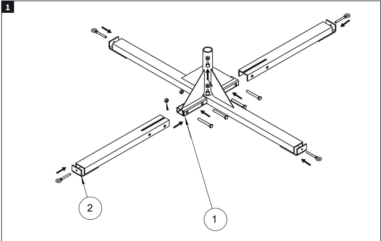
**1** Assembler les deux pieds, insérer les vis et les boulons (x4)
