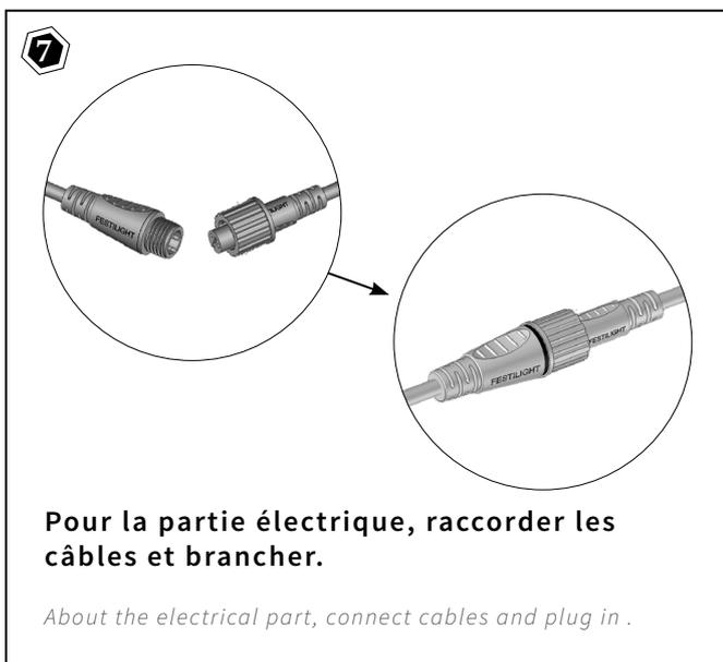
**Pour la partie électrique, raccorder les câbles et brancher.**
