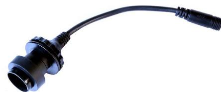
L'adaptateur B22 sert à raccorder une ampoule ou un produit avec une douille de connexion. L'ampoule B22 n'est pas fournie avec. Elle mesure 0,28m de longueur. L'adaptateur 230V est conçu aussi bien pour l'intérieur que pour l'extérieur. IP44.
