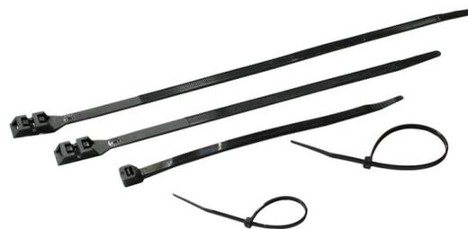
Notre collier de câblage en Nylon 6.6® est vendu en lot de 100, il est spécialement conçu pour tous types de câblage (général, machines, automobile, électroménager,...). Il est de couleur noir et mesure 292mm de longueur pour 3,6mm de largeur. Son diamètre est de 85mm à son maximum de serrage. Avec une charge maximum de 18kg, il est conçu aussi bien pour l'intérieur que pour l'extérieur.
