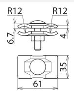
Pour la connexion de deux conducteurs parallèles avec une vis.
