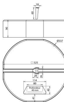
Plot béton pour pointes de capture, pour la protection de petites structures sur toits plats, pour le montage de supports écarteurs DEHNiso, par ex. pour des conducteurs circulaires isolés ou pour des pointes de capture sur trépied.
