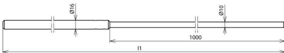
Pointe de capture avec rétrécissement (1000 mm), chanfreinée, pour la protection des structures de toit, des cheminées, etc., installation possible sur plot béton à clavettes 17 kg ou pour la fixation avec supports de barres / supports écarteurs.
