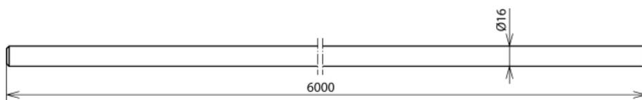
Pointe de capture avec diamètre 16 mm, à découpe sur place.
