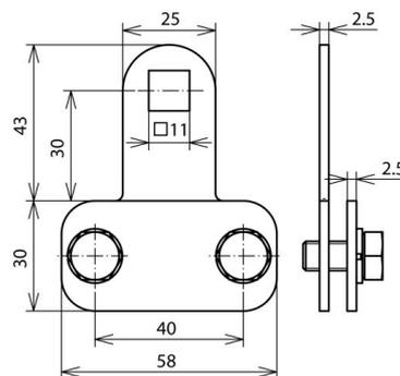
Pièce de serrage avec rondelle Grower pour le raccordement de matériel plat à des éléments de construction.
