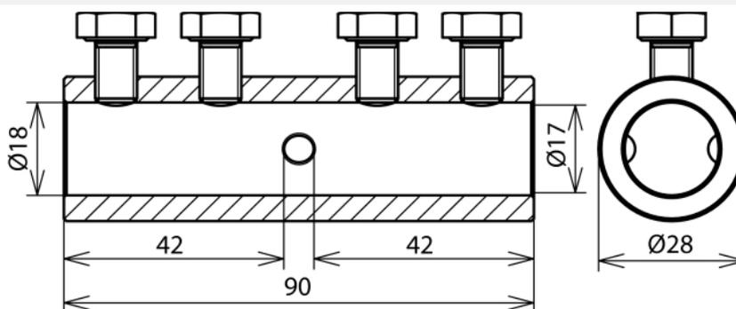
Manchon avec marquage (cran) pour le rallongement de pointes de capture (rd 16 mm), avec quatre vis M8 (protégées contre un desserage intempestif).
