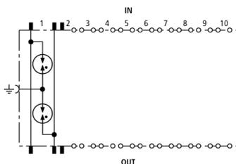
Schéma de principe du circuit DPL 10 G3 110
