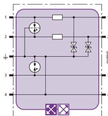
Schéma de principe du circuit BXT ML2 BE S 36
