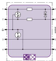
Schéma de principe du circuit BXT ML2 BD DL S 15
