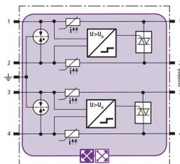
Schéma de principe du circuit BXTU ML4 BD 0-180
