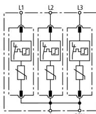
Schéma de principe du circuit DG M TNC 440
