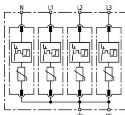
Schéma de principe du circuit DG M TNS 275 NL FM
