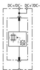
Schéma de principe du circuit DSE M 1 242
