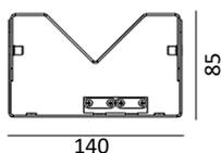
Cette pièce sert à déporter l'applique vers l'avant ou à l'installer sur un angle de mur saillant.
