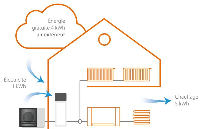
Explication : pour 1 kWh d'électricité consommée, la pompe à chaleur va restituer jusqu'à 5 kWh de chaleur selon les conditions climatiques et le type de logement.
