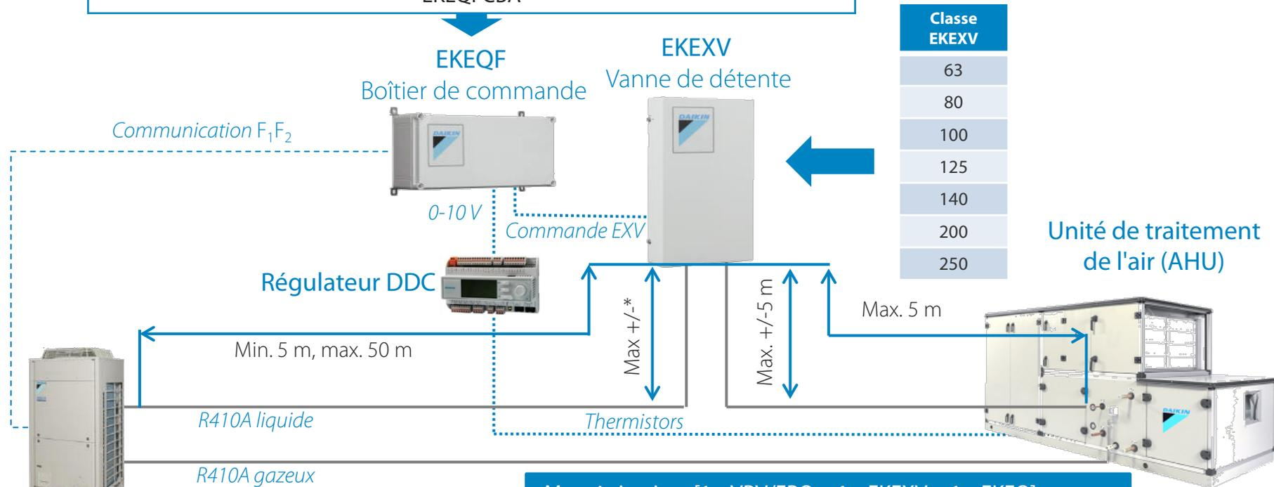
Max. 4 circuits x [1 x VRV/ERQ + 1 x EKEXV + 1 x EKEQ] comme décrit ci-dessus dans un serpentín entrelacé et une AHU
