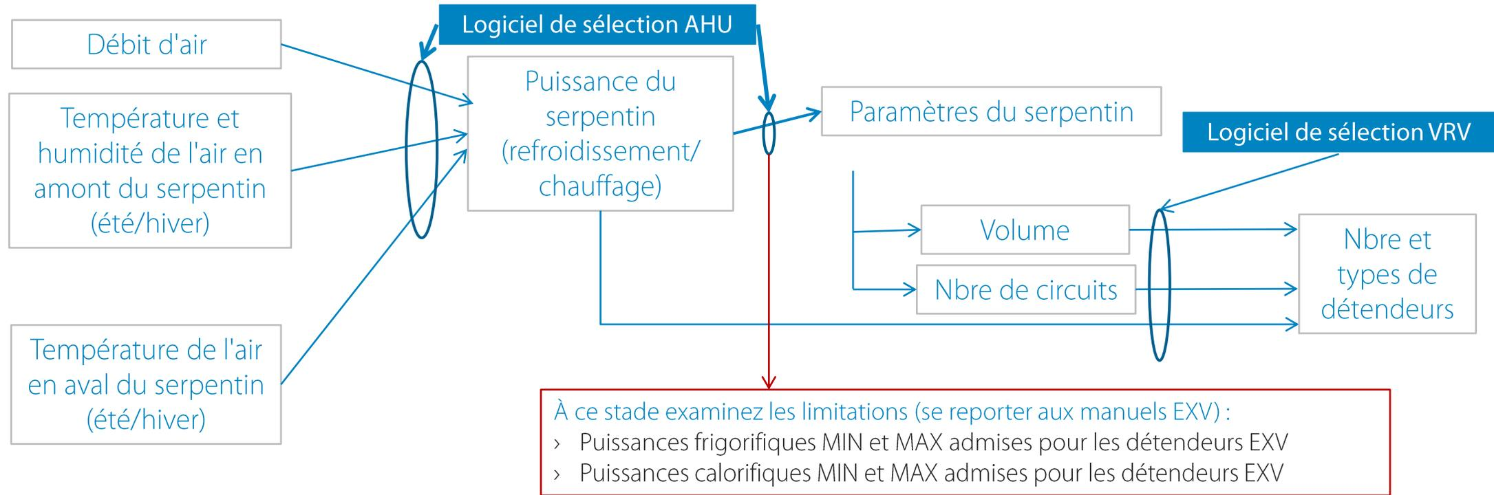
La manière de sélectionner le détendeur dépend du type d'application AHU en question :
