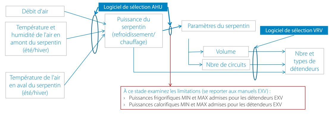
La manière de sélectionner le détendeur dépend du type d'application AHU en question :
