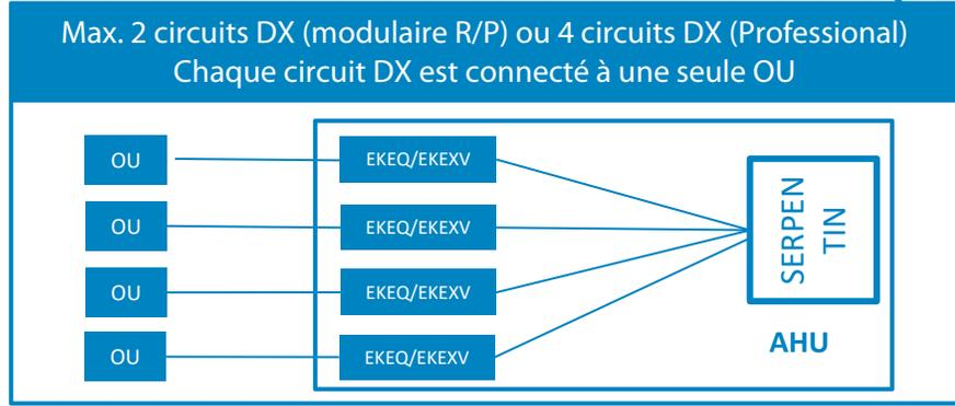
**Remarque :** Les limitations applicables sur le taux de connexion, la longueur des tuyauteries et la dénivellation sont identiques à celles des applications de tiers. Voir les dispositifs des cas 2 et 3.
