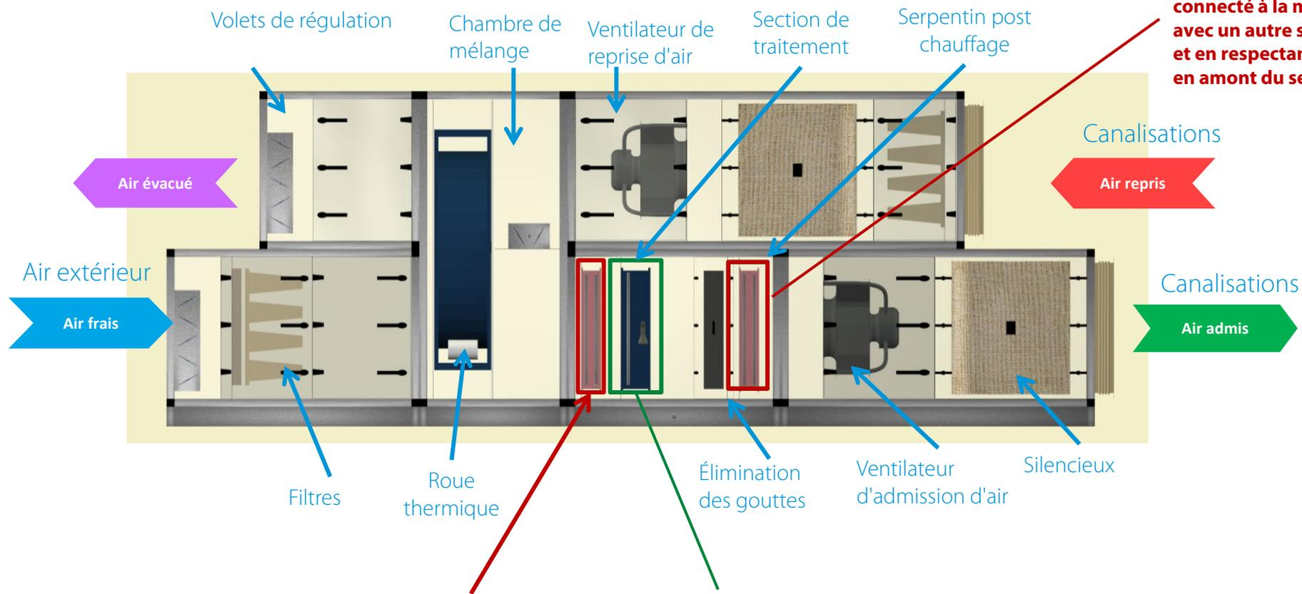
**Vous pouvez ici également utiliser un serpentin DX avec une unité ERQ/VRV pour le post-refroidissement ou post-chauffage de l'air d'admission, mais non connecté à la même unité extérieure avec un autre serpentin de la même AHU et en respectant les limitations de l'air en amont du serpentin.**
