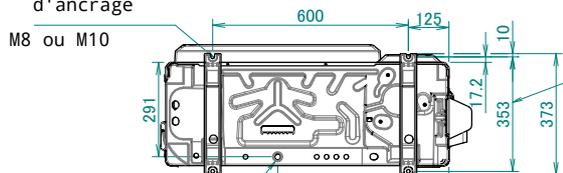
Espacement entre les trous des boulons de fondation
