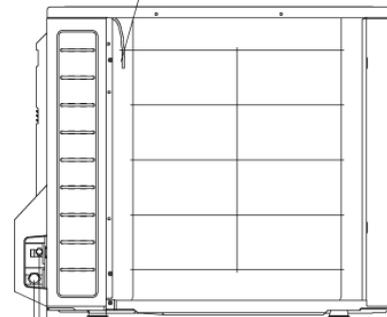
Robinet d'arrêt sur ligne liquide ( $\varnothing$  6,4CuT)
