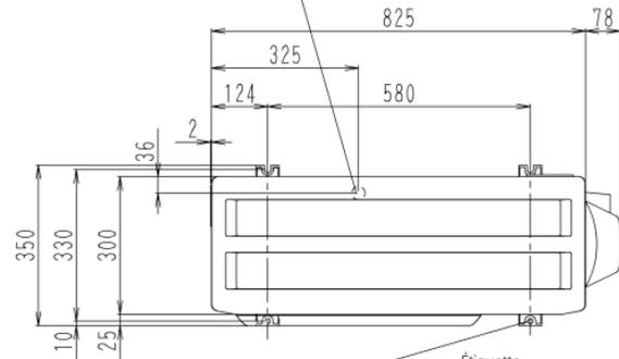
4 trous pour boulons d'ancrage (M8 ou M10)
