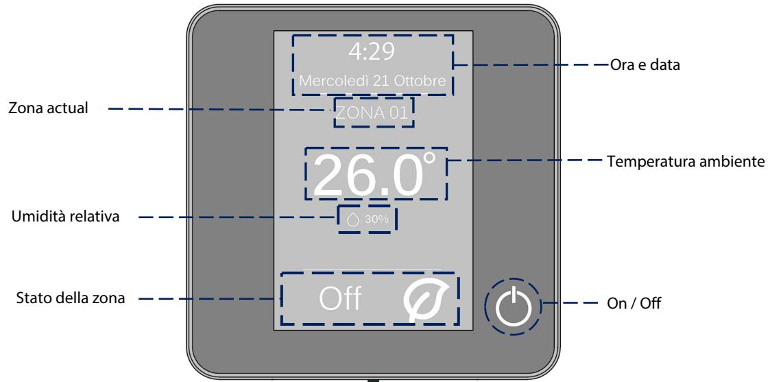
**Ora e data.** E' possibile impostare questo parametro. (*Vedi sezione configurazione dell'utente*).
