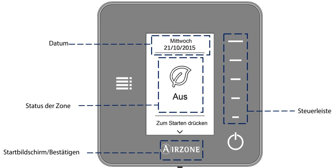
**Datum.** Info-Parameter, der durch die Master-Schnittstelle in der Benutzerkonfiguration festgelegt wird (*Siehe Abschnitt Benutzerkonfiguration*).
