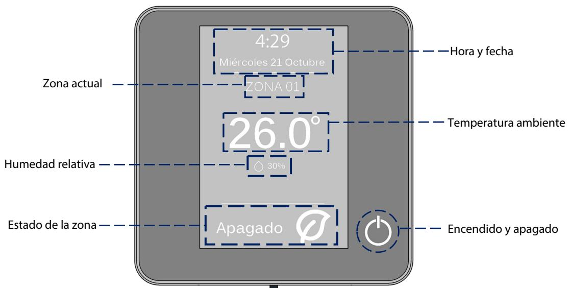
**Hora y fecha.** Se trata de información configurable; se puede definir en el menú de configuración de usuario. (*Ver sección configuración de usuario*).
