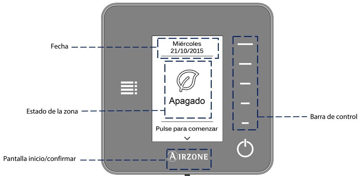
**Fecha.** Parámetro informativo definido por la interfaz maestra en la configuración de usuario (*ver sección Configuración de usuario (Airzone Blueface)*).
