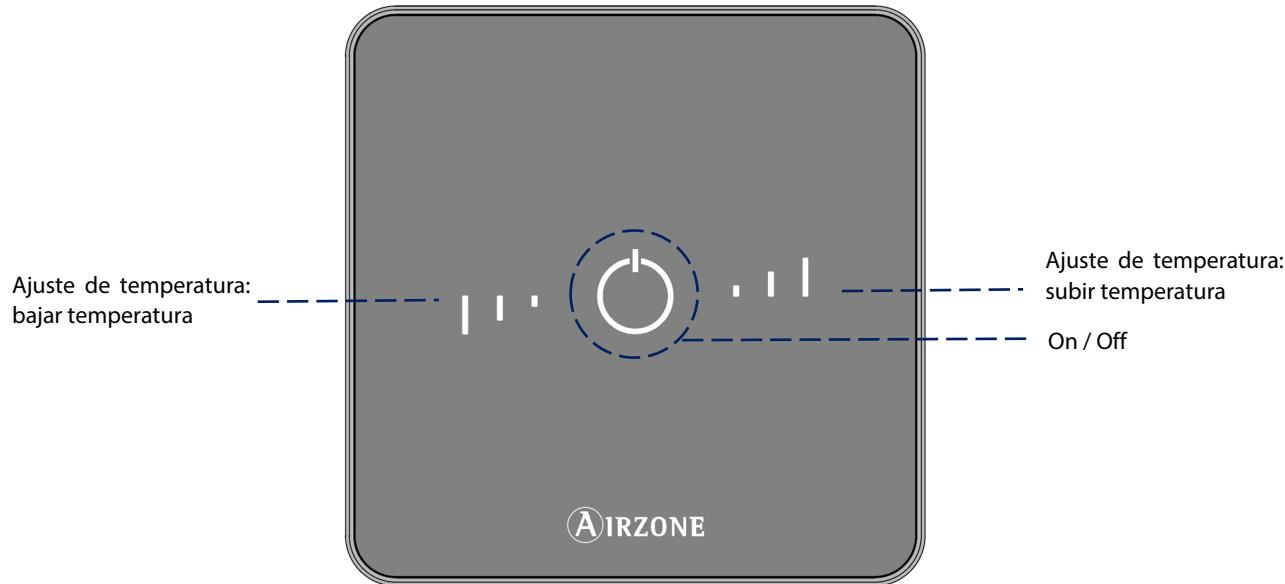
**On/Off.** Encendido y apagado de la zona. Además, actúa como indicador del modo presentando diferentes colores para cada situación. (Ver sección *Funciones básicas, On/Off*).
