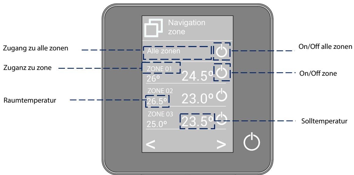
Die Option „Alle Zonen“ ermöglicht die gleichzeitige Steuerung aller Zonen, die zum System gehören, in dem sie alle Änderungen an diese übermittelt.
