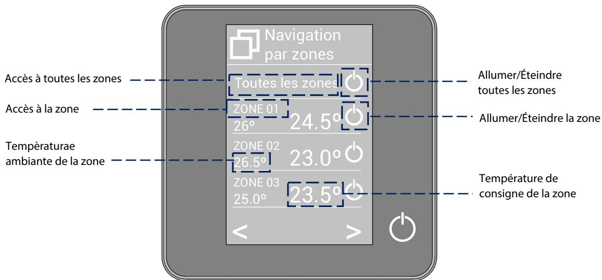
L'option « Toutes les zones » permet le contrôle simultané de toutes les zones, en leur relayant les modifications apportées. Appuyez sur le nom de la zone pour la contrôler à distance depuis le contrôleur. Lorsque le système détecte une erreur de température dans une zone concrète, la zone affiche le code d'erreur au lieu de la température ambiante de la pièce (voir la section *Notifications et incidences*).
