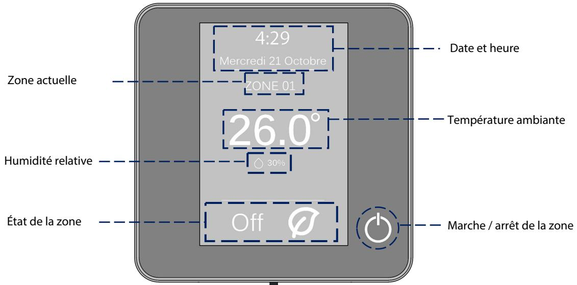
**Date et heure.** Il s'agit d'une information configurable qui peut être définie dans le menu de configuration de l'utilisateur (*Voir section Configuration utilisateur*).
