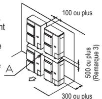
**(E) Plusieurs rangées d'installation en série (sur le toit, etc.)**
