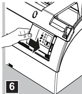
6. Faites glisser le panneau de commande conformément aux instructions pour fixer les crochets 1 et 2 en position.
