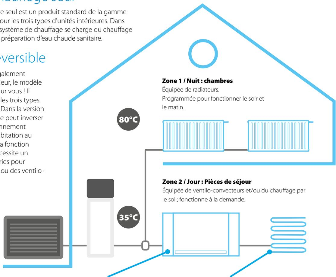
Également appelés convecteurs pompe à chaleur, les **ventilo-convecteurs** sont des émetteurs hydroniques qui peuvent assurer le rafraîchissement comme le chauffage. Ils peuvent être combinés et s'associent à merveille avec les systèmes de chauffage par le sol.
